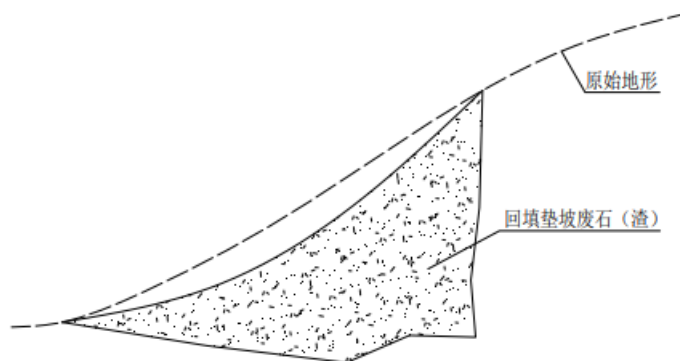
图2-2 采坑垫坡工程示意图
