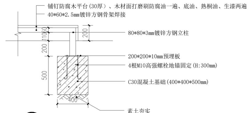
⑥ 立柱基础剖面图 1:20
