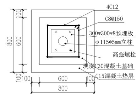
③ 立柱基础平面图 1:20
