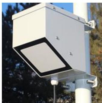
图 10 雷达表面流速仪
