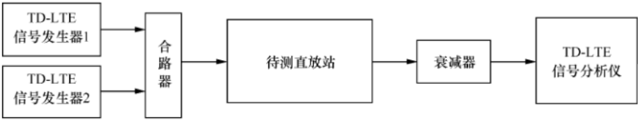
图 5 输入互调测试连接
