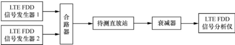
图 4 输入互调测试连接示意
