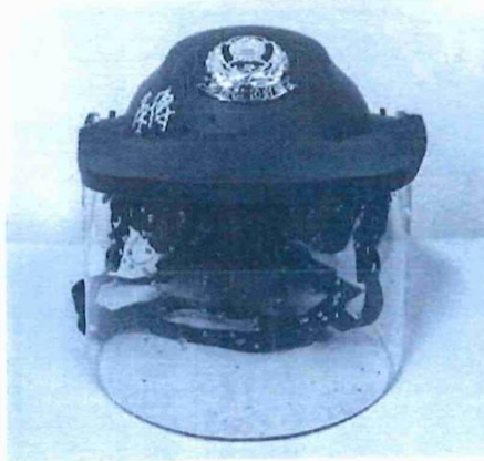
图2、FBK-AL-ZZ-06型警用防暴头盔(防霰弹性能实验后)
