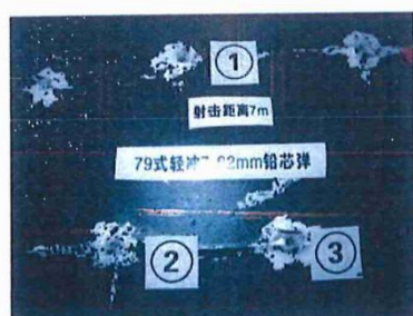
图三: 常温条件下, 7m距离处防弹盾牌正面弹伤状态。
