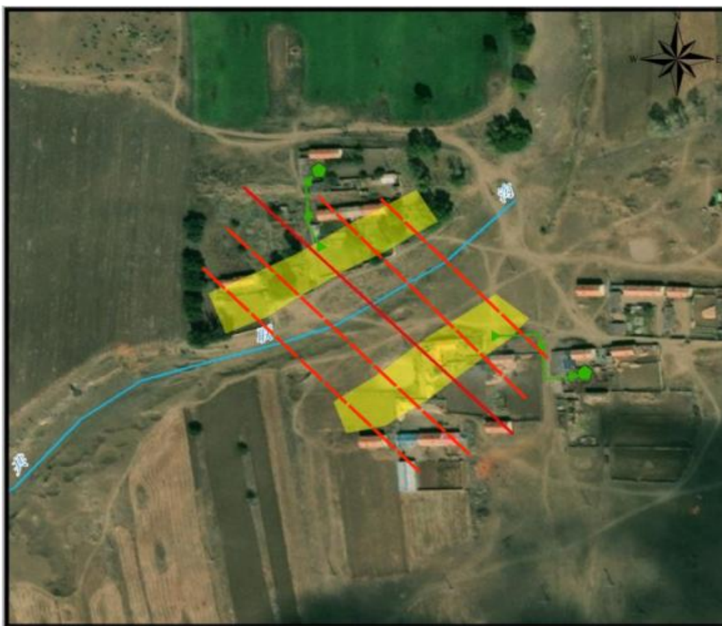
图 2-12 河道加密测量示意图
