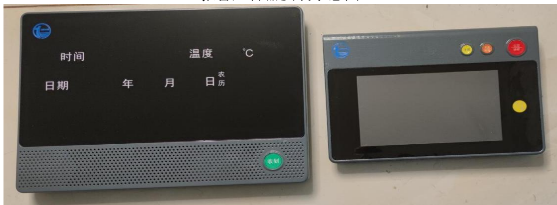
入户报警器参考示例：左侧为呼叫器，右侧为报警应答器
