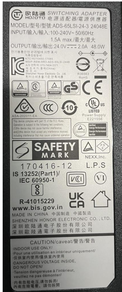
电源适配器 (型号: ADS-65LSI-24-3 24048E) 铭牌
