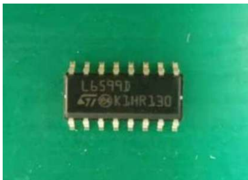
开关电源主控 IC (位号: UH1, 型号: L6599D)
