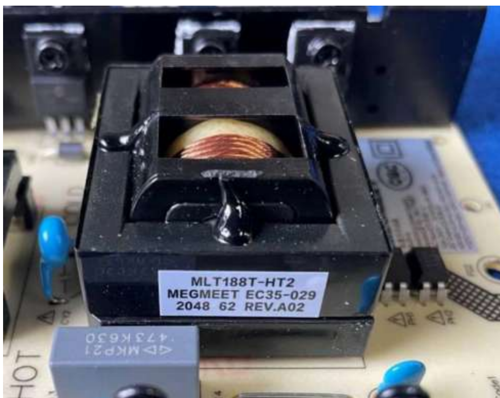
HT2 变压器标识 (型号: EC35-029 其它字符为企业内部代码)
