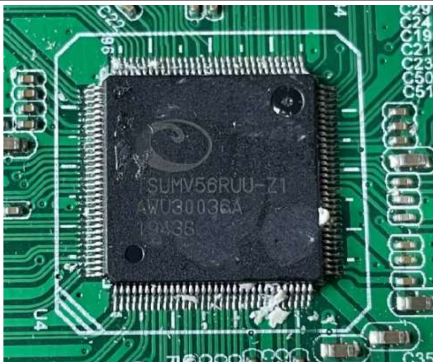
主板主控 IC (型号: TSUMV56RUU-Z1)
