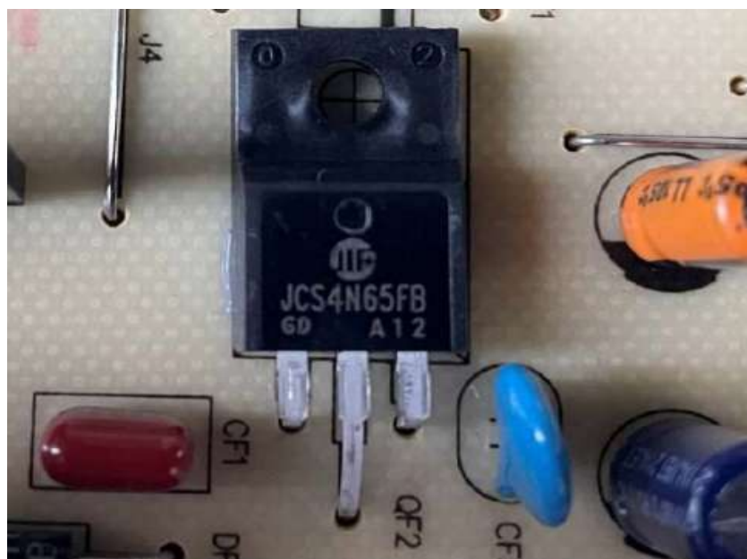
开关电源开关管 (位号: QF2, 型号: JCS4N65FB)
