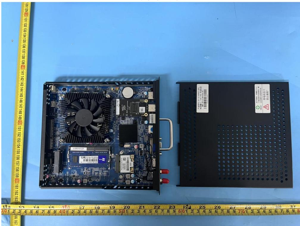
插拔式计算机内部结构
